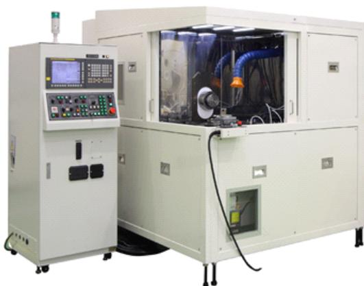
写真7 5軸制御超精密非球面加工機 (2008年)
