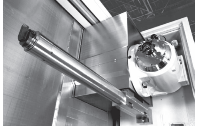
図7 ロングボーリングバーによる深穴加工
