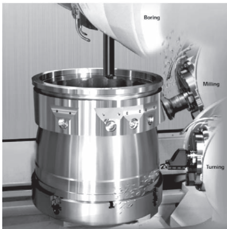
図5 複合作業機械（マシニングセンタ型）による加工例
